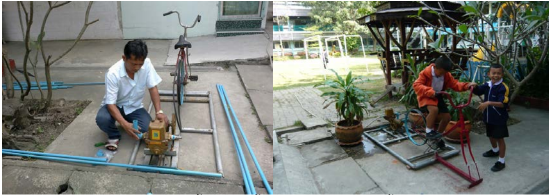
รูปที่ 13 การสร้างจักรยานปั่นน้ำ เพื่อนำน้ำเสียที่บำบัดแล้วมารดน้ำสนามหญ้าของโรงเรียน
