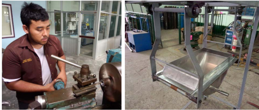
ภาพที่ 7 การผลิตและประกอบชุดถังร้อน
