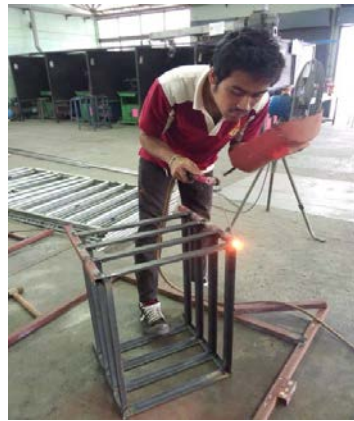
ภาพที่ 8 เชื่อมประกอบชุดโครงรับตะแกรง
