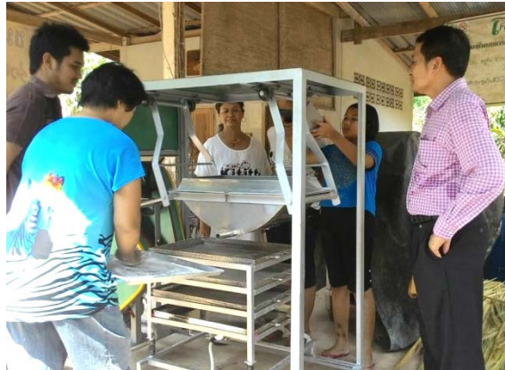
ภาพที่ 10 การทดลองใช้งานเครื่องผลิตเม็ดแป้งสาकुที่สร้างขึ้น
